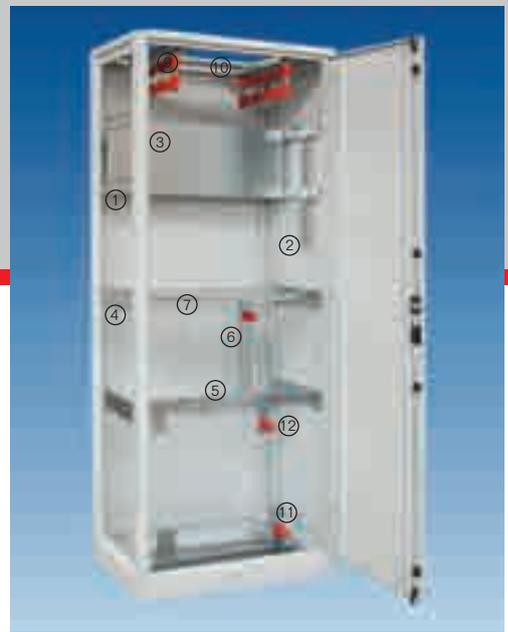
① **Seitenmontageschiene** mit 25mm-Raster, □ 9,5mm, d=4mm, h=50mm, Stahl verzinkt
