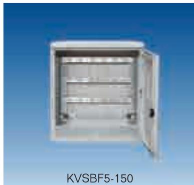
**Kabelverteilschränke** inklusive Verschiebung, vorbereitet für NH-Unterteile, Schienenabstand 185mm, Polyester ähnlich RAL 7035 Lichtgrau, IP34D
