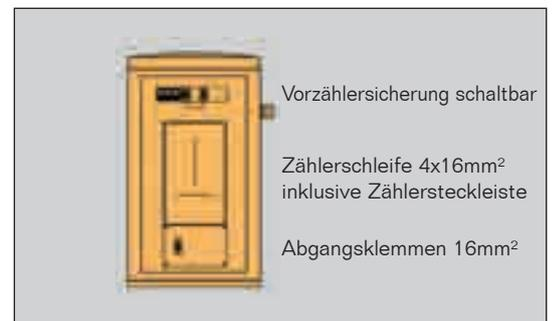
**Hausanschluss-Zählerverteiler-Freistehend für Kabel**
