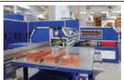
Die Verschiebungswerkstätte ist speziell für den Bau von Verschiebungsverteilern ausgerüstet. Schaltanlagen mit Nennströmen bis 5000 Ampere werden hier gefertigt.
