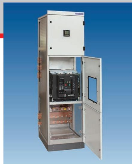
Die Kuppelfelder ermöglichen im Bedarfsfall die Zuschaltung anderer Energieeinspeisungen oder Notstromaggregate. Oberhalb des Leistungsschalters können bei Bedarf die Steuersicherungen und Steuergeräte (z.B. für automatische Umschaltung) montiert werden.
