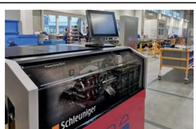
Trotz individueller Fertigung wird bei ERA ein großes Augenmerk auf Automatisierung und Optimierung gelegt. Mit den vollautomatischen Drahtbearbeitungsmaschinen werden die Drähte abgelängt, abisoliert, beschriftet und mit Anschlussmitteln konfektioniert.
