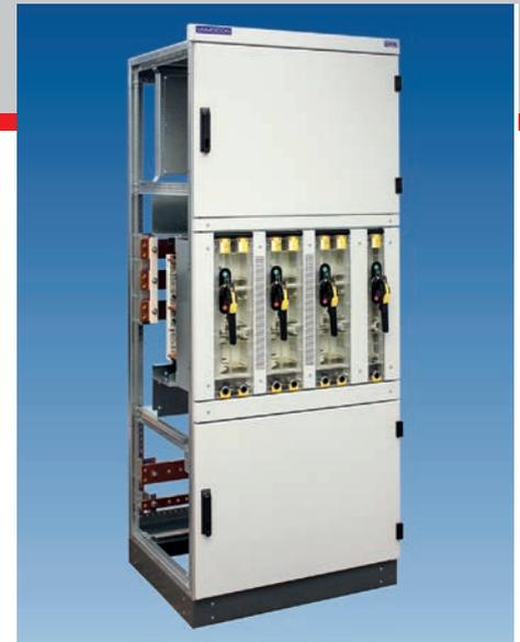
In Stecktechnik-Abgangsfeldern können NH-Lasttrennleisten in Schubeinsatz-technik und Steckmodule mit einzelner Fronttür eingebaut werden. Das Verteilsammelschienensystem ist hinter den Einbauten berührungssicher abgedeckt (IP00B), und erlaubt deshalb ein gefahrloses Auswechseln der Einschübe unter Spannung. Kabelabfangschienen sorgen für die geeignete Kabelbefestigung.
